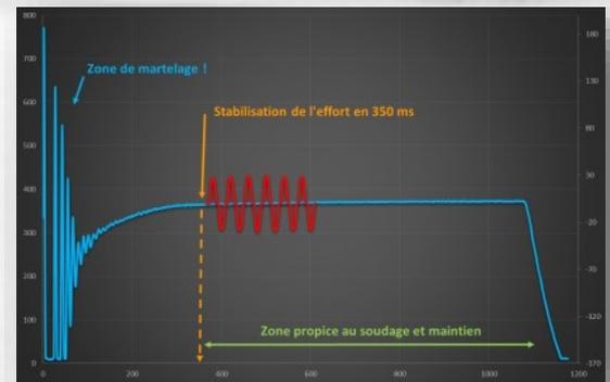
Mesure de la valeur d'**énergie** pour le point soudé et valeur de la **résistance** électrique;
